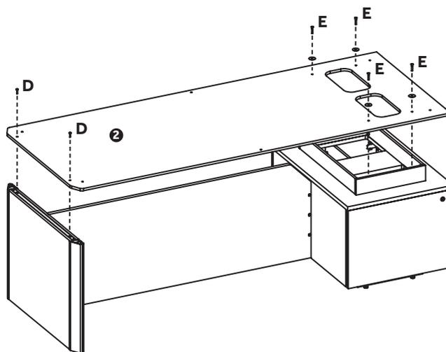
4. Fixe o tampo superior(1) no tampo base(2), com os parafusos M6x25(D).
